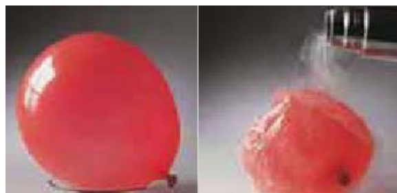
Cuando se vierte nitrógeno líquido (-196°C) sobre un globo, el gas disminuye su temperatura y su volumen disminuye, mientras la presión permanece constante.
